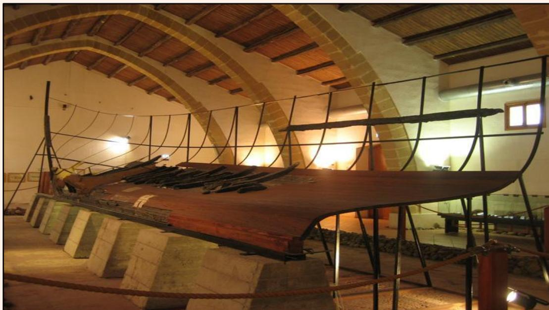
Le bateau devait long de 35 mètres et large de 4,80 mètres. Il était haut de 2 mètres et demi et avait une jauge de 120 tonnes. Il pouvait accueillir un équipage de 68 rameurs, 34 par côté, qui actionnent 17 rames de chaque flanc. On a déduit qu'il s'agissait d'un bateau punique parce que sur le bordé sont gravées les lettres de l'alphabet punique.
